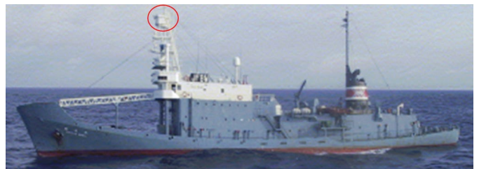
トップバレルを有する鯨類目視調査船(赤丸内がトップバレル)
