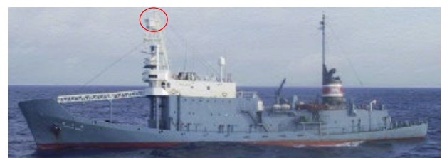
図7. トップバレルを有する鯨類目視調査船 （赤丸内がトップバレル）
